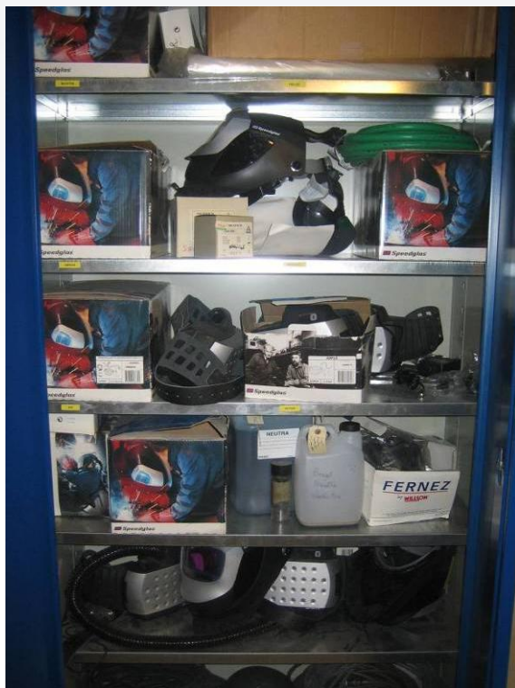
Opbevaring af åndedrætsværn i skab
